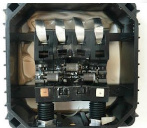
Boîte de jonction d'un panneau avec les trois diodes
