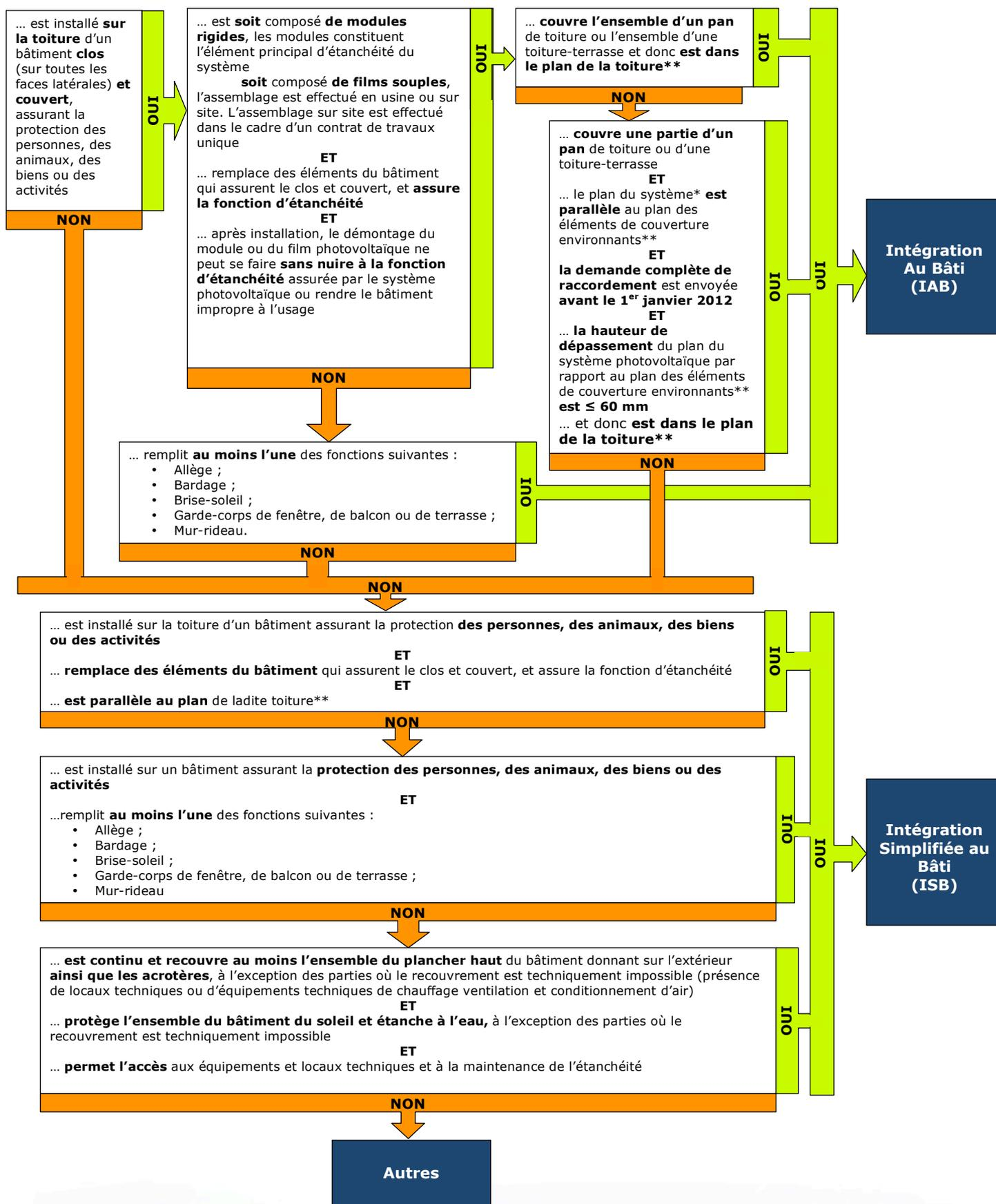
\* le plan du système est défini comme étant le plan tangent aux points hauts du champs des modules photovoltaïque, hors éléments en saillie (châtières, abergements, élément de ventilation du procédé...)
